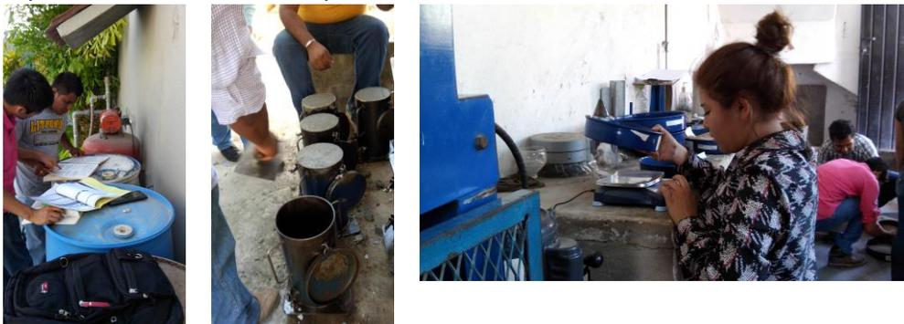
Figura 11. Preparación de cilindros de Mezclas de Concreto
